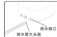
1. 将排水管的大头端对准洗衣机的排水接口，并插紧。
