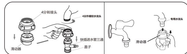
1. 4分外螺纹水龙头安装：先将4分转接头旋转拧紧安装在4分外螺纹水龙头上，再将快插进水管三通的滑动器下压，安装到4分转接头上。
